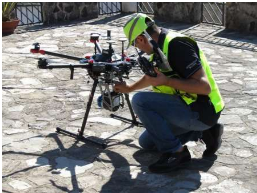
Fig. 4. Attività di rilievo fotogrammetrico e LIDAR da drone, realizzato dal Consorzio NET - Natura, Energia, Territorio.
